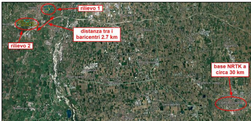
Figura 274 - In alto a sinistra le aree di due distinti rilievi posti ad una distanza tra loro (dai rispettivi baricentri) di 2.7 km. In basso a destra la base GPS della rete ubicata a 30 km dai rilievi.
