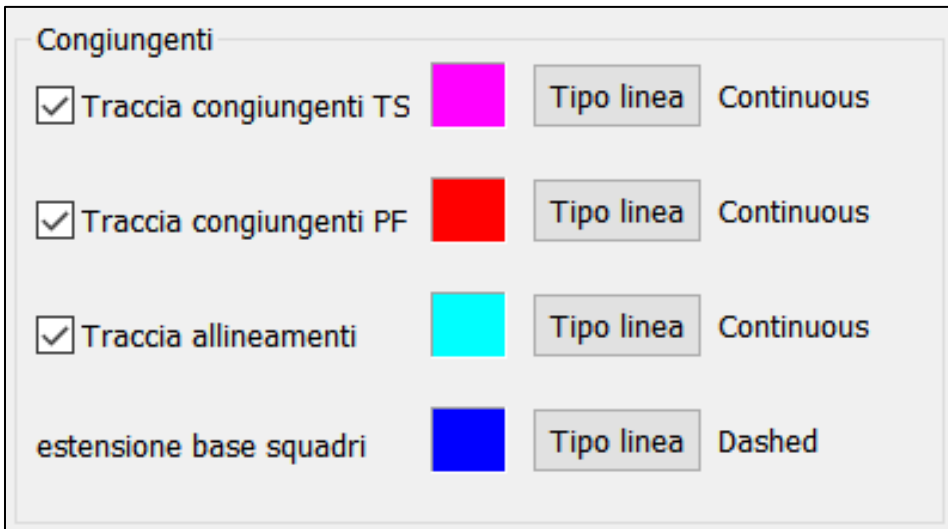
Figura 197 - L'applicativo topografico di Geocat include nel disegno anche le congiungenti tra: stazioni; stazioni-PF; allineamenti, linee delle quali permette di personalizzare il colore e il tipo-linea.
