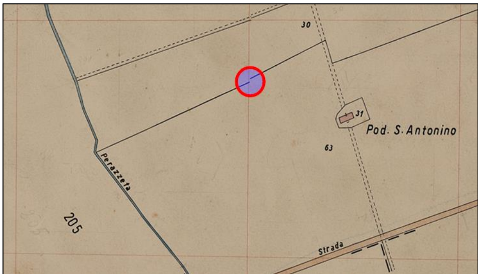
Figura 94 – Se la deformazione tra due quadranti adiacenti è significativamente diversa può succedere che, nella mappa ricampionata dalla Parametrica, una linea originariamente retta che passa da un quadrante all'altro presenti uno scalino sul parametro intermedio.
