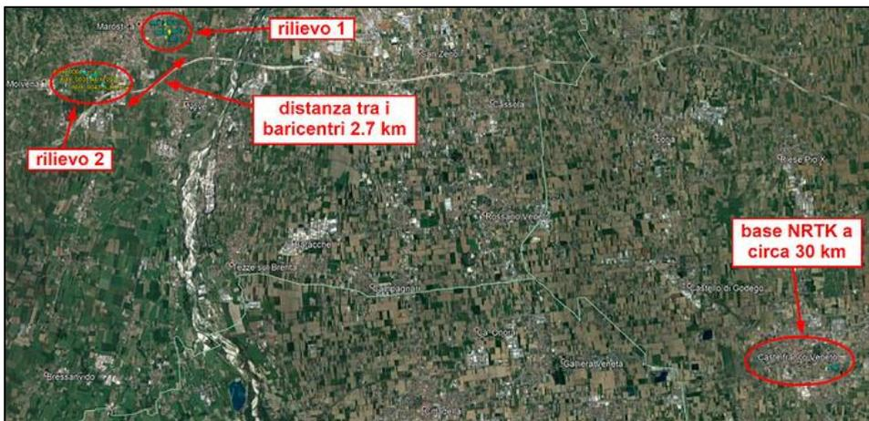
**Figura 276** – In alto a sinistra le aree di due distinti rilievi posti ad una distanza tra loro (dai rispettivi baricentri) di 2.7 km. In basso a destra la base GPS della rete ubicata a 30 km dai rilievi.
